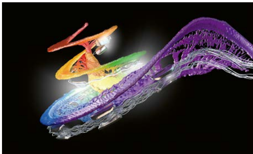
Die entscheidende Komponente: Die Elektrode des Cochlea-Implantat-Systems, die in die Hörschnecke eingeführt wird. Sie sendet elektrische Signale an den Hörnerv.
