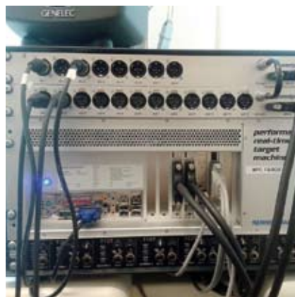
Abbildung 2: Der Prototyp des Forschungs-sprachprozessors, der xPC
